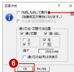
包絡処理を行った状態の躯体データから図面を作成する場合は、チェックを付けます。躯体のラインを加筆修正している場合は、チェックを付けると編集前の状態で作図されますので、注意してください。
