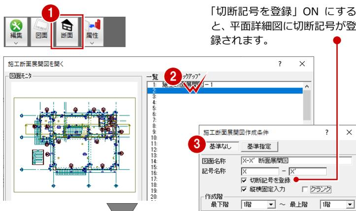
「切断記号を登録」ON にすると、平面詳細図に切断記号が登録されます。
