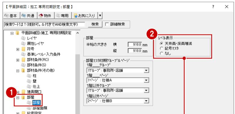
部屋入力時に、右図のように部屋の「天井高 CH+」と「床高増減 FL±」を表示します。
