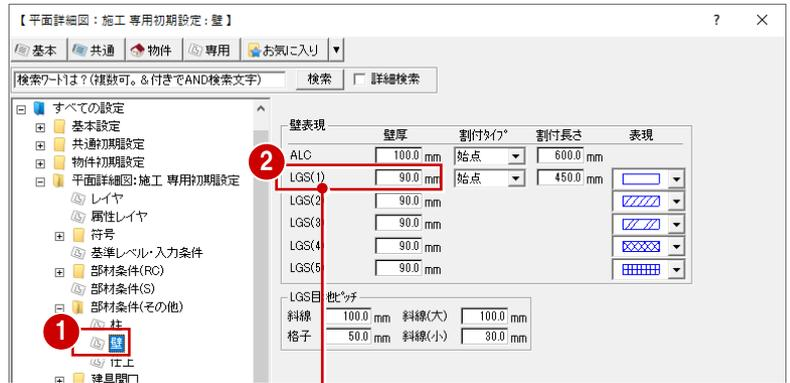
本書では、「自動」メニューの「壁自動配置」を使用して、LGS 壁 (間仕切り壁) を自動配置します。⇒ P.14
