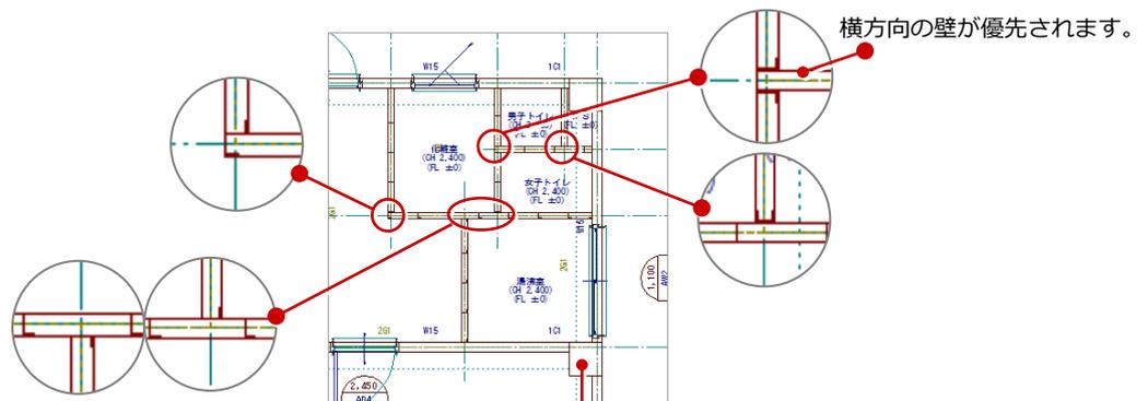
この操作によって柱壁が包絡されていない状態に戻りますが、再度、P.20「一括処理の実行」で柱壁の包絡処理を行います。
