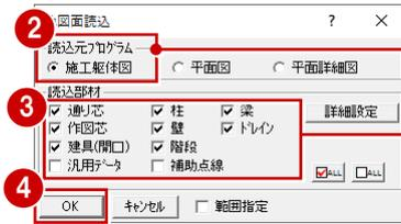
鉄骨躯体図データを読み込む場合も、「施工躯体図」を ON にします。
