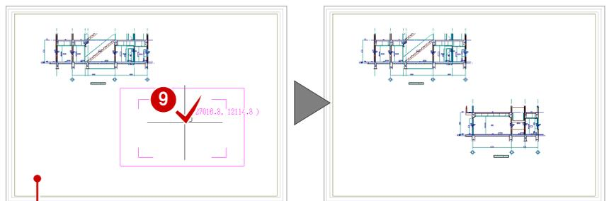
● 通り芯を揃えて平面詳細図と断面展開図を1枚の図面に合成することもできます。
