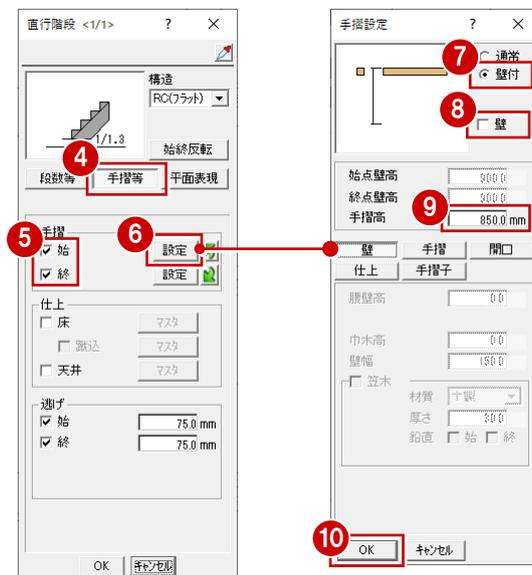
次に、終点側の手摺に始点側の手摺の設定を複製して、始点側の手摺と同じ設定にします。
