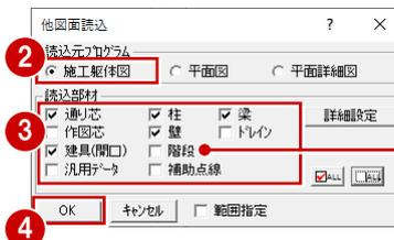
作図芯と階段は、RC 躯体図データを使用せず、3 階平面詳細図の作図芯と階段を使用します。そのため、ここでは読み込まずに「3 階のデータを複写する」で複写します。
