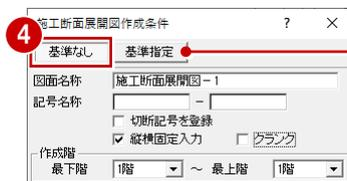
切断面を指定するときに基準としたいライン（通り芯や壁・梁などの線）を指定する場合、「基準指定」をONにします。
