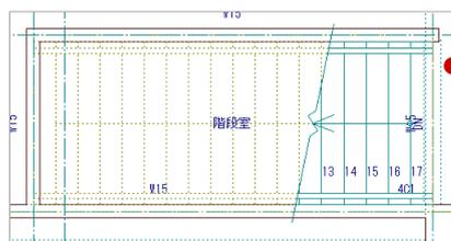
※ 3 階の階段を階複写すると、自動的に階段属性が下向き導線、立体・断面不出力に変更されます。
