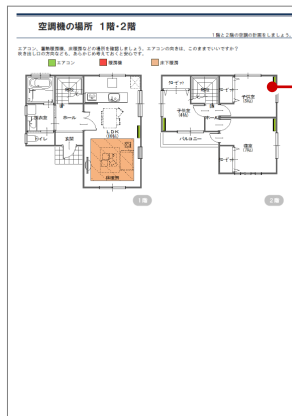
【空調機の場合 1階・2階】
