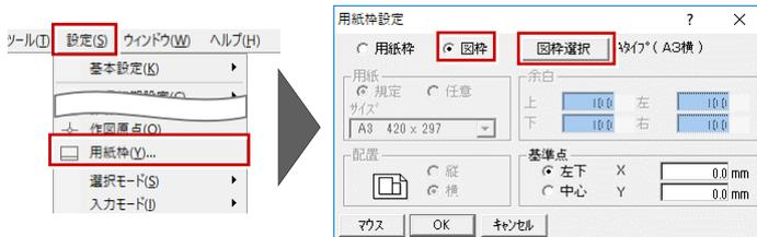
図面を初めて開いたときに表示される図枠は、「物件初期設定：初期グリッド・用紙」の【図枠設定】で選択したものです。
