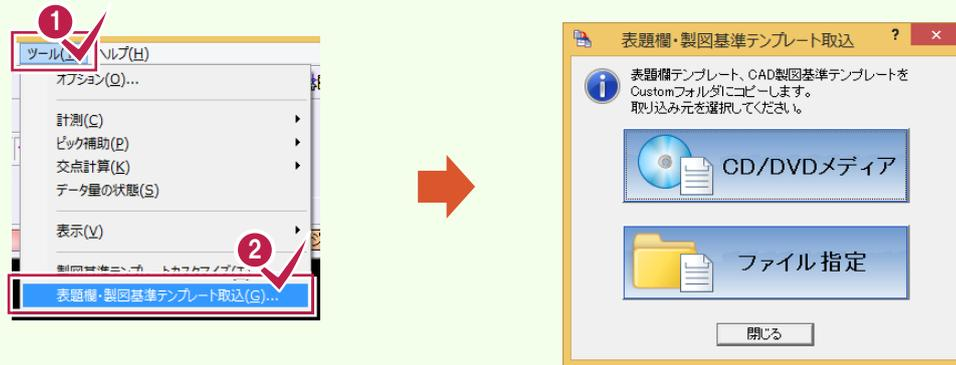
取り込んだ表題欄テンプレートは、[図枠・表題欄]ダイアログの[表題一覧]ボタンをクリックして表示される[表題一覧]ダイアログの[その他]で確認できます。([図枠・表題欄]ダイアログの[対応基準])にもリストとして追加されています。)
