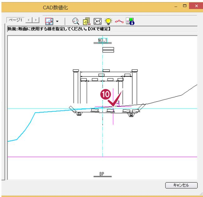
10 分岐点から、再度断面に使用する線をクリックします。
