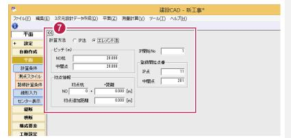
計算方法で「エレメント法」を選択し て、計算方法、路線名、NO杭のピッ チなどを設定します。
