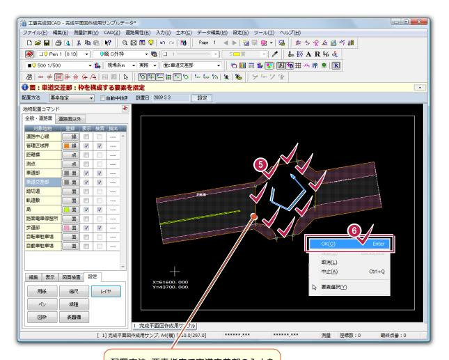
配置方法:要素指定で車道交差部の入力を 解説していますが、配置方法:閉合図形でも 入力できます。
