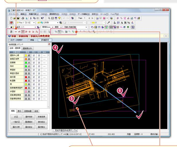
マウスでデータの交点を正確にクリックするために、ツールバーの[ピック: マーク] [ピック:端点] [ピック:フリー]をクリックしてオフの状態にし、[ピッ ク:交点]のみオンの状態にします。
