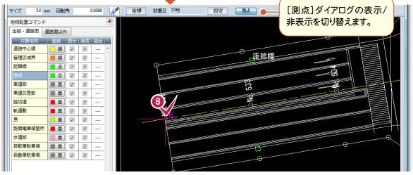
そのほかの測点も同様に測点の属性を設定して、測点の位置をクリックし入力します。
