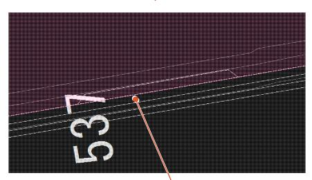
エラー部分の隙間を既存の歩道部と結合して、1つの歩道部のデータに修正します。
