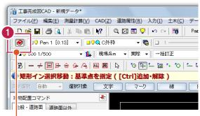
1 入力属性ツールバーで[CAD製図基準連動]を確認します。
