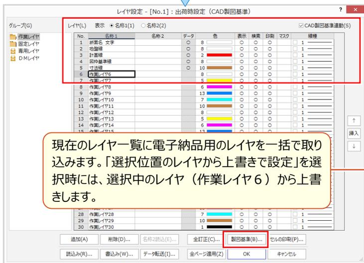
現在のレイヤー一覧に電子納品用のレイヤを一括で取り込みます。「選択位置のレイヤから上書きで設定」を選択時には、選択中のレイヤ（作業レイヤ6）から上書きします。
