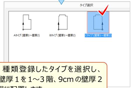
壁厚を2種類登録したタイプを選択し、10cmの壁厚1を1~3階、9cmの壁厚2を4~5階に配置します。
