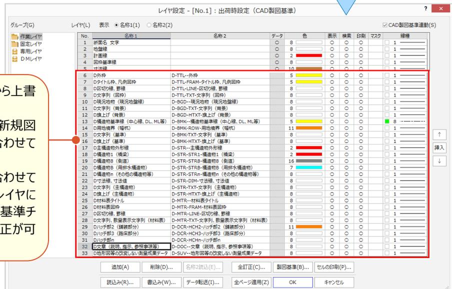
選択した【作業レイヤ6】から上書きで追加されます。色、線種も設定されるため、新規図面作成時にも製図基準に合わせて作図することができます。既存の図面を製図基準に合わせて修正する場合には、正しいレイヤに移動することで【CAD 製図基準チェック】で色と線種の自動修正が可能です。
