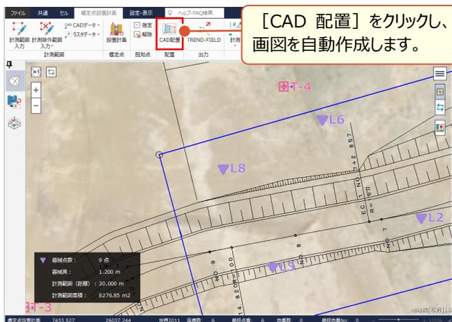
[CAD 配置] をクリックし、標定点配置計画図を自動作成します。
