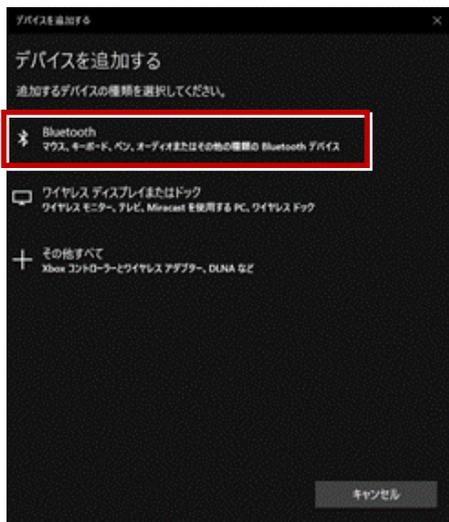
4 付近のBluetoothデバイスが検索されます。接続する器械をタップします。
