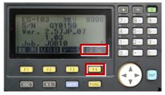
**2** 矢印キーで「通信条件」を選択して [ENT] を押します。
