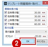
「簡易枠見付幅」は、「簡略」「標準」表現のときに2D・3Dで表示される簡易枠の見付幅になります（建具表の枠見付もこの値です）。なお、「詳細」表現のときは、実際のディテールの幅で表示されます。
