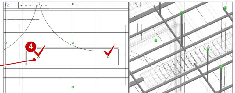
吊りボルトはインサート内に○印が作図されます。
