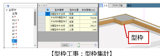
【型枠工事：型枠集計】
