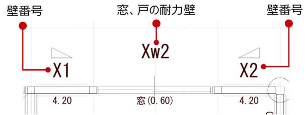
窓、戸の耐力壁(有開口壁)は、窓・戸の端部どちら側にも、他の耐力要素(壁、窓、戸)と連続していない場合、壁基準耐力は0となります。この場合、「壁番号自動配置」を実行したとき、壁基準耐力が表示されません。
