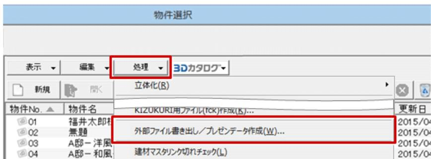
3 「外部ファイル書き出し」ダイアログの「専用図面選択」で Ctrl キーを押しながら対象の図面をクリックし、「次へ」をクリックします。
