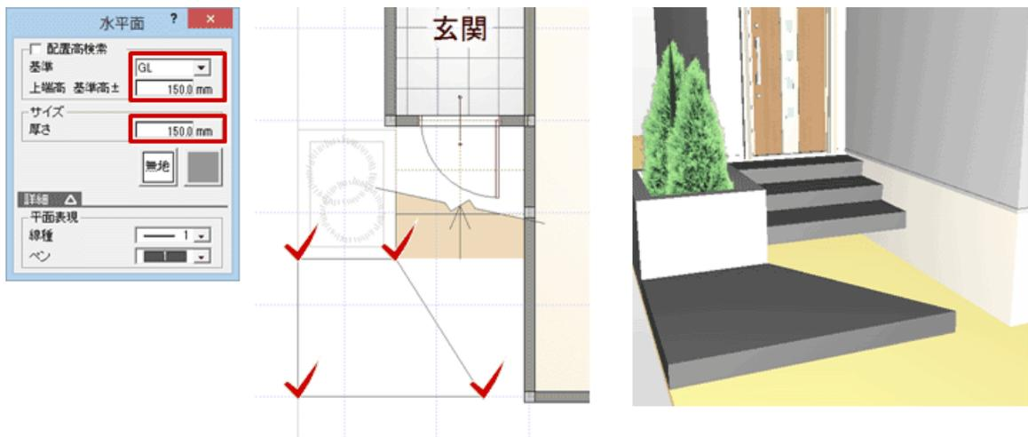
8 続けて、「厚さ」を「300」、「上端高」を「300」にして、2段目の形状を入力します。
