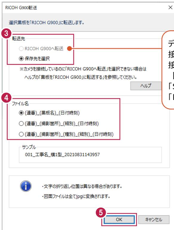
デジタルカメラ「RICOH G900」が接続されている場合に選択できます。接続しているのに選択できない場合は「保存先を選択」でカメラに挿入している「SDカード名」、もしくは「RICOHDCI」「RICOHDCX」を選択してください。
