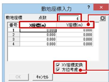
● お手元の測量図の値が「mm」単位表示の場合には、配置図の「専用初期設定：丸め・マーク設定-設定1」の「敷地座標」で単位をmmに変更します。
