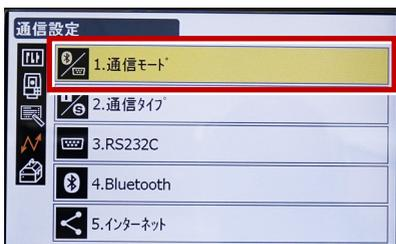
4 「通信モード」を「Bluetooth」に設定して「ENT」を押します。
