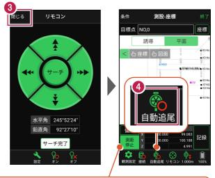
プリズムがロックされると自動で測距が開始されます。 測距を停止する場合は、[測距停止] タップします。 測距を再開する場合は、「測距開始] をタップします。
