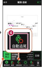
プリズムがロックされると自動で測距が開始されます。 測距を停止する場合は、[測距停止] タップします。 測距を再開する場合は、[測距開始] をタップします。
