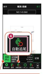
プリズムがロックされると自動で測距が開始されます。 測距を停止する場合は、[測距停止] タップします。 測距を再開する場合は、[測距開始] をタップします。
