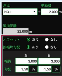
また [拡幅片勾配] を「あり」にした場合は、各測点に設定されている拡幅量、前後の測点、カーブのタイプなどを考慮して左右の位置が計算されます。
