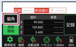
器械が「手動」の場合は、設置位置までの「水平角」と「水平距離」を確認できます
