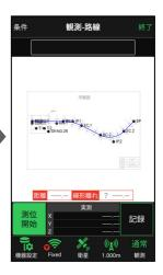
幅杭など線形を オフセットした 線上を観測する場合は、左または右の オフセット値を入力します。 ⑤ [測位開始] をタップする と、GNSSによる測位が開始 されます。
