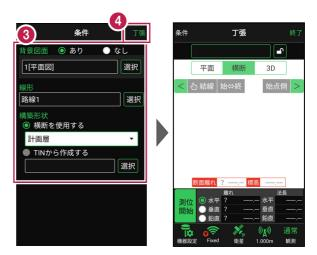
⑤ [測位開始] をタップする と、GNSSによる測位が開始 されます。
