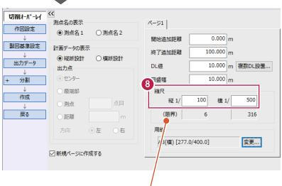
縦横の縮尺は、限界縮尺を参照して入力してください。 限界縮尺とは、選択した用紙サイズに図面がおさまるように 計算された縮尺のことです。
