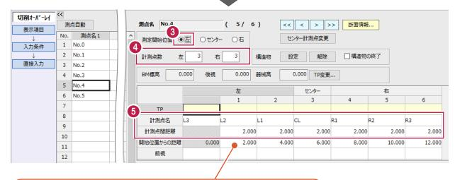
[計測点間距離]から[開始位置からの距離]が自動計算されますが、 開始位置(ここでは左側の測点)からの追加距離を入力することもできます。
