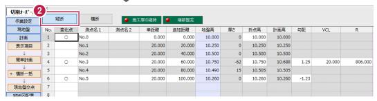
③ [横断] を選択します。各断面の計画高、勾配などを確認します。
