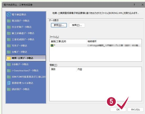
ボーリング交換用データ(BEDNNNN.XML)の作成と、「ボーリング交換用データフォルダ」(¥DATA)への登録を行います。(NNNNは、ボーリング連番:0001から開始)
