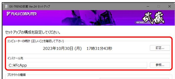
※ コンピューターの時計が正しくないと、プロテクトが正常に動作しません。
