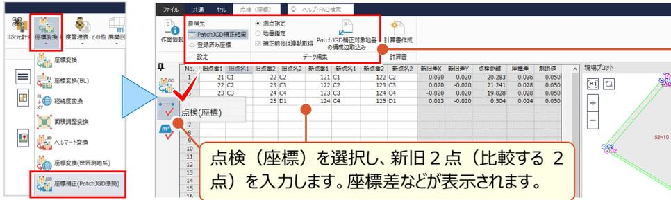
点検（座標）を選択し、新旧2点（比較する2点）を入力します。座標差などが表示されます。
