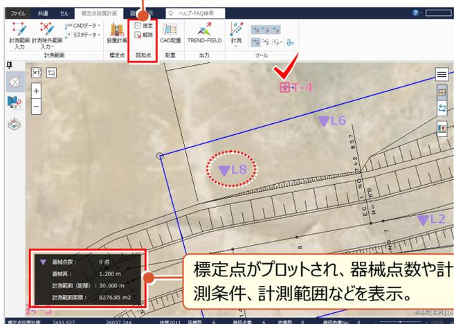
標定点がプロットされ、器械点数や計測条件、計測範囲などを表示。
