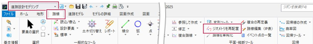
[ジオメトリを再配置] をクリックし、道路モデルの中心線、新しい路線の順に選択します。
