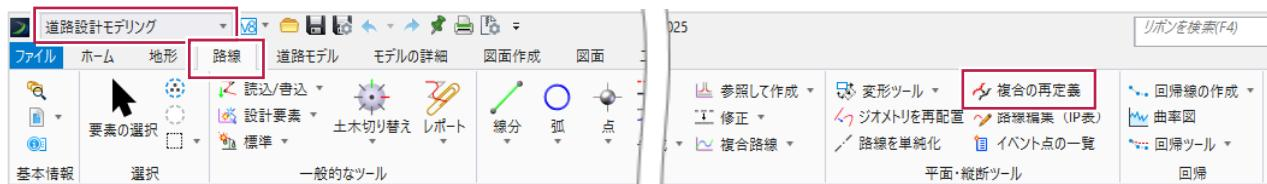
平面線形に縦断線形が含まれている状態で、[複合の再定義] を使用します。
