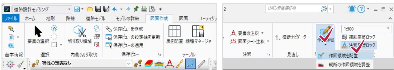
2 ダイアログで [横断の作図領域を配置] を選択し [図面シード] で「JPN A1 横断図」を選択します。
