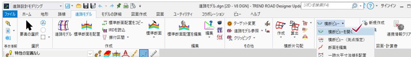
2 平面ビューで道路モデルを指定し、右側のビューをクリックして、横断ビューを表示します。
