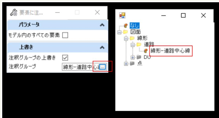
3 左クリックでダイアログ内容を確定し、次に平面線形をクリックします。右クリックでこの操作を完了します。
