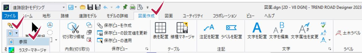
2 [ツール] - [アタッチ] で、先に作成した「線形.dgn」「地形.dgn」「道路モデル.dgn」を選択して [開く] をクリックします。参照ウィンドウは閉じます。
