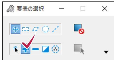
2 標準横断図の側溝を選択します。不要な線を選択した場合は、ダイアログの [−] で減らせます。
