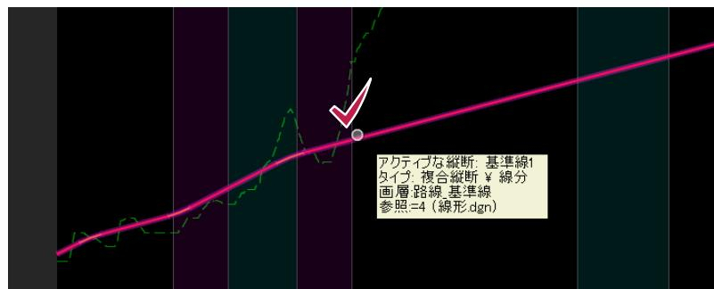
4 開始位置の測点 No.0 部分でクリックすると、作図領域が表示されず、左下のステータスバーに「領域は指定されたパラメータに適合しません。」と表示されます。
