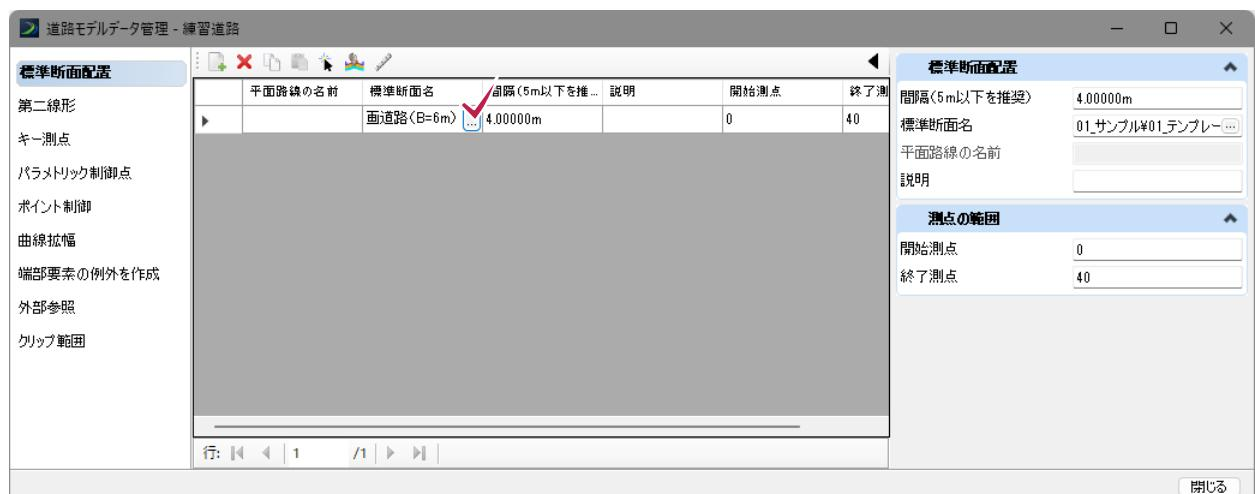
5 [標準断面を選択] から「標準断面\_練習」を選択し [OK] をクリックします。[道路モデルデータ管理] を閉じます。
