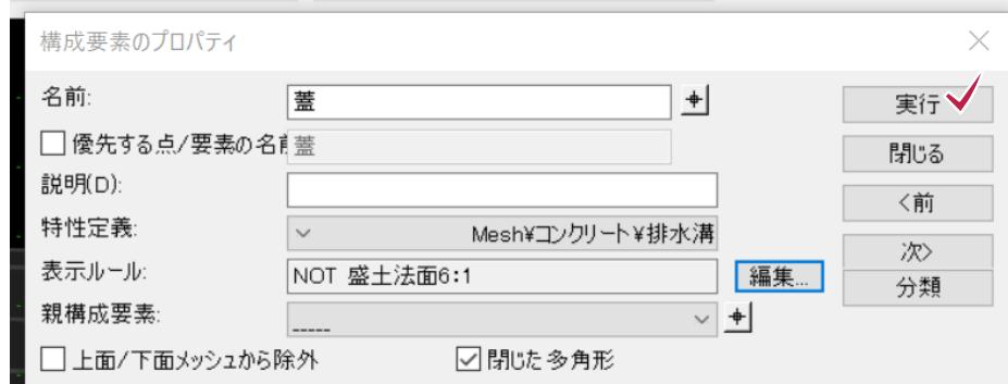
6 反対側の側溝にも、同様の表示ルールを設定します。「蓋 1」の構成要素のプロパティを開き、表示ルールの [編集] をクリックします。
