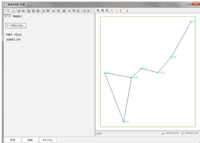
1 [配置2]グループ-[基準点網図]-[基準点網図配置]をクリックします。
