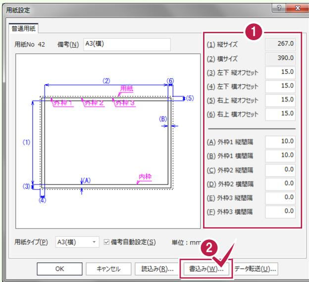
**1** 用紙が設定されている画面を参考に各ボックスに値を入力して用紙枠を設定します。
