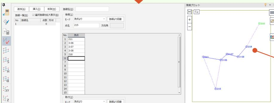
点検計算を行います。点検計算を行う前に必ず手簿計算を行ってください。
