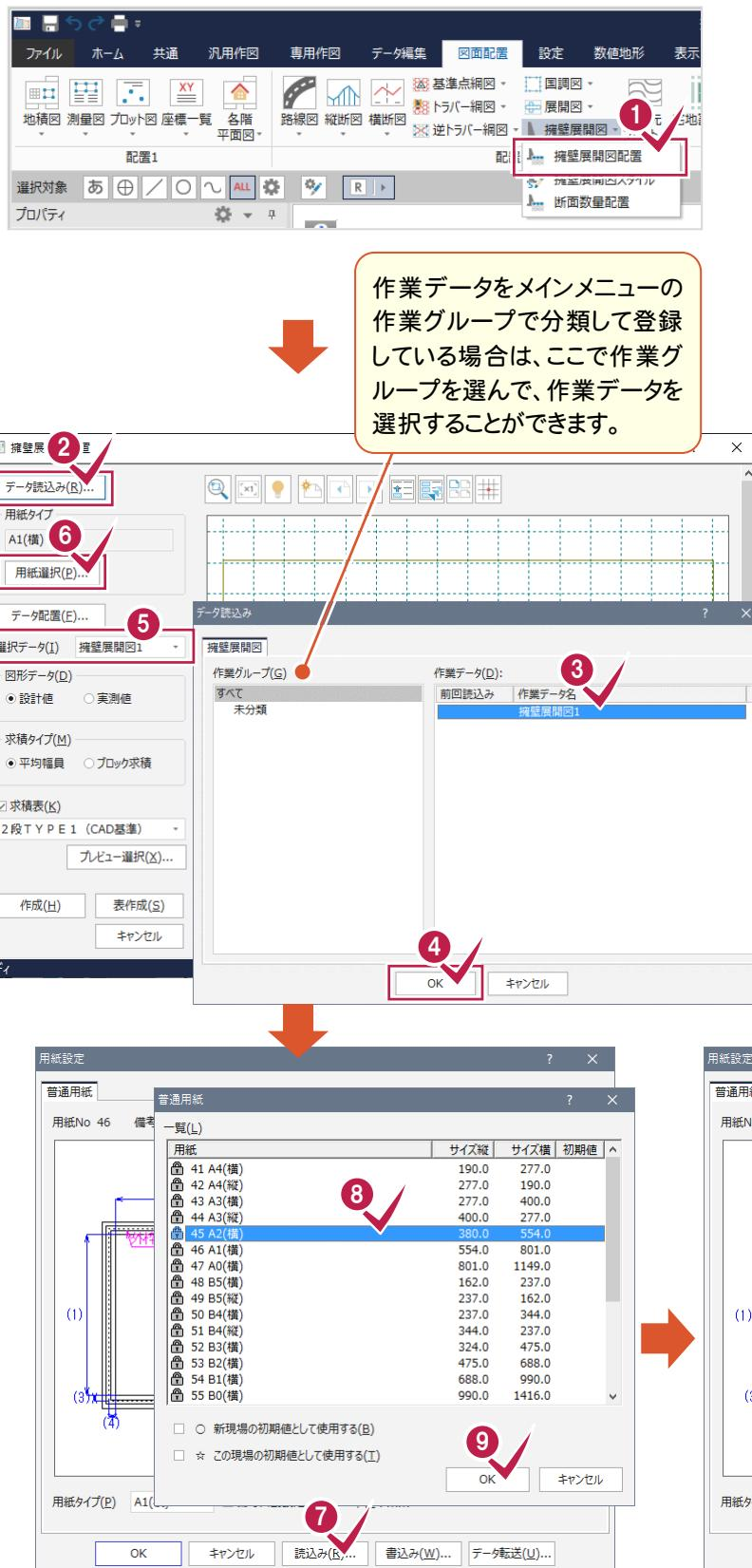
1 [配置2]グループ-[擁壁展開図]-[擁壁展開図配置]をクリックします。
